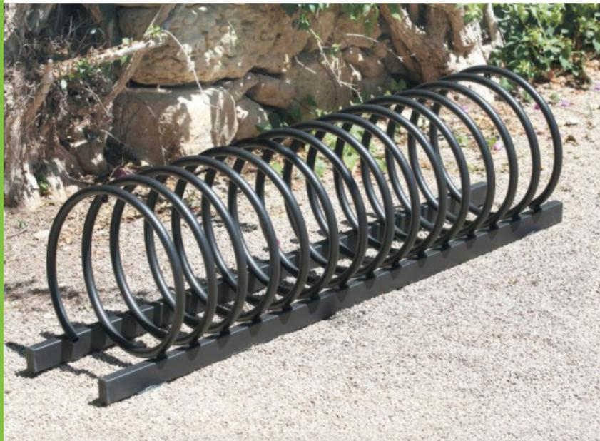
Portabiciclette a spirale con struttura portante in tubo di acciaio di sezione rettangolare di 50x25x2mm. Fermaruota in tubo di acciaio di sezione tonda da 20x2mm. Articolo zincato e verniciato, munito di predisposizione per l'ancoraggio al suolo e di tappi in PVC inestraibili alle estremità.
